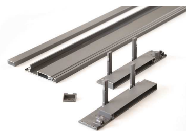
B592 لوازم اینتر ریل اسلیم شیشه با فرانت آلومینیوم و ارتفاع ۱۹۳mm سایز برش فرانت آلومینیومی : عرض داخل به داخل - ۹۷mm سایز برش میله گالری : عرض داخل به داخل - ۷۲mm
