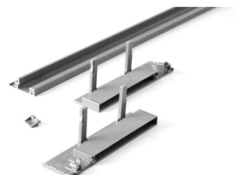
B594 لوازم اینتر ریل اسلیم شیشه با فرانت شیشه و ارتفاع ۱۹۳mm سایز برش فرانت آلومینیومی : عرض داخل به داخل - ۹۷mm
